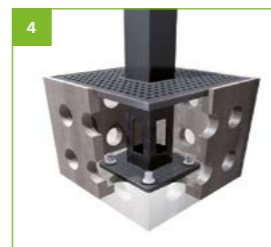
Concrete foundation / vegetation support: Custom concrete foundation designed to mount the column. Dimensions: 760x760x580mm / 29.9" x 29.9" x 22.8" Closed by a perforated aluminum grid Grid thickness: 25mm / 1" Massif de liaison au sol / Support végétation En béton, équipé pour recevoir le mât Dimensions : 760x760x580 mm Fermé par une grille ajourée en découpe d'aluminium (épaisseur 25 mm)
