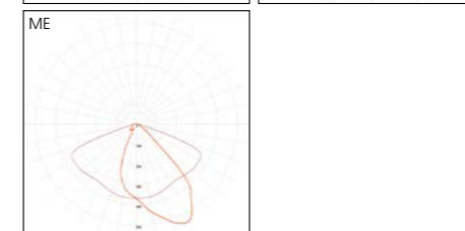
Photométries du luminaire seul - photométrie globale variable selon découpe. Photometric of the luminaire alone - global photometric depending on cutting pattern.
