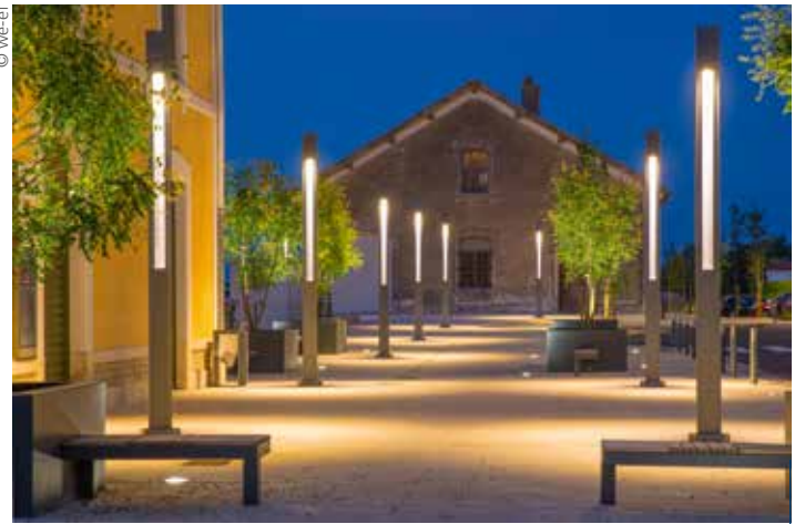
De classe 1 et IK10, la colonne LTP444 LED-FT de la société We-ef se distingue par ses trois faces éclairantes et ses 'traits de lumière' verticaux. Son corps est en fonte d'aluminium.
