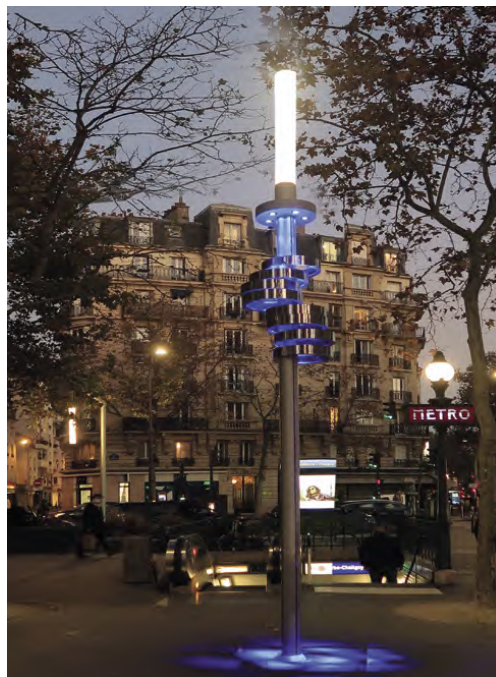
Place Mireille-Havet, Paris 11e arrondissement. Dessinés par l'agence Concepto, les mâts ont été réalisés et fabriqués par Technilum et équipés de luminaires existants : Comatelec pour le Totem et Sammode pour le lampadaire de salon. Maîtrise d'ouvrage : Ville de Paris – Maîtrise d'œuvre : Evesa – Conception Lumière : Concepto © Concepto
