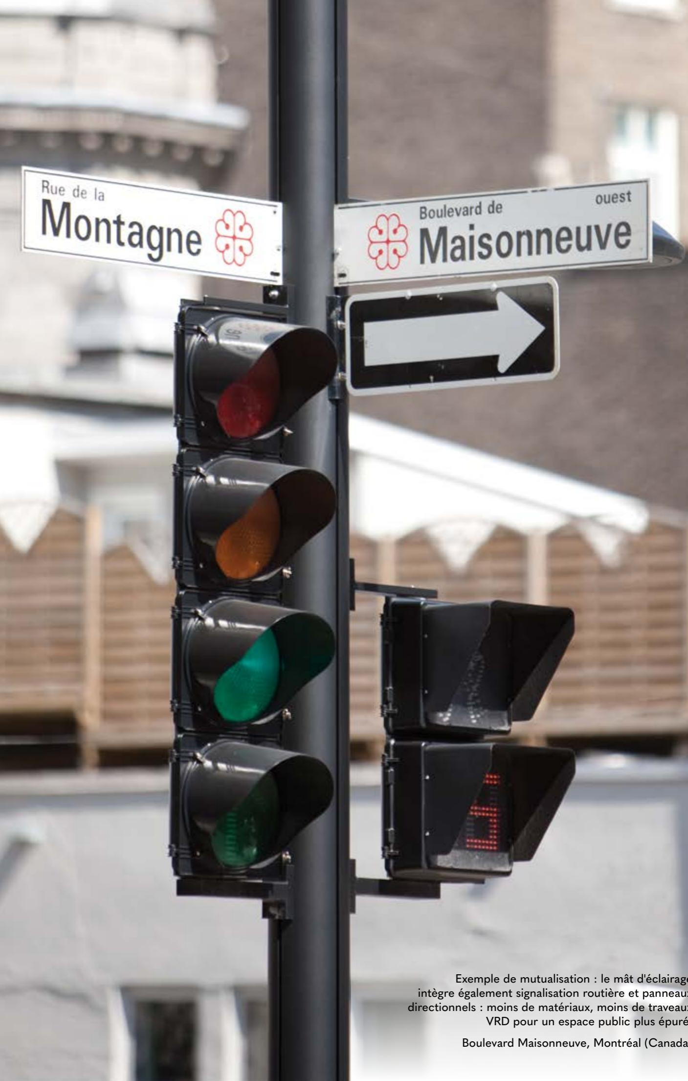
Exemple de mutualisation : le mât d'éclairage intègre également signalisation routière et panneaux directionnels : moins de matériaux, moins de travaux VRD pour un espace public plus épuré.
